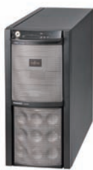
TX150 S6 稼働時：34dB 待機時：25dB
