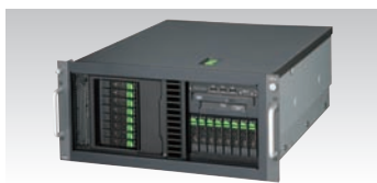
2.5インチSASモデルでハードディスク16台搭載時
