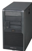
TX100 S1 稼働時：21dB 待機時：21dB
