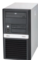
ECONEC 100 S2 稼働時:21dB 待機時:20dB
