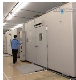
経年変化試験 高温高湿状態での加速試験により、部品品質の信頼性を評価
