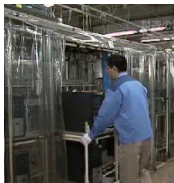
高温ランニング試験 お客様構成（外付け除く）において、高温状態での長時間ランニングによる評価
