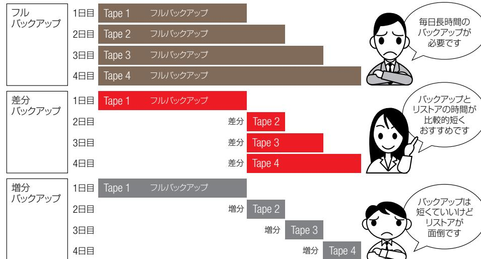
差分バックアップも増分バックアップも、一度フルバックした後でないといけません。バックアップデータをリストアすることを考えると、フルバックアップしたテープと最後の差分バックアップだけで済む、**差分バックアップがお勧めです。**
