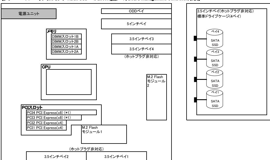
(\*1) PCIスロット3/4は、PCI Express 4.0(x8)[Full Height] × 2またはPCI Express 4.0(x16)[Full Height] × 1の切り替えが可能です。また、PCI Express 4.0(x16)[Full Height]に切り替えた場合、PCIスロット3は使用できず、PCIスロット4のみ使用できます。
