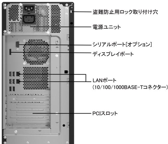
【タワーベースユニット (3.5インチ HDD/SSD × 4/250W電源 × 1、Board Management Controller対応)】
