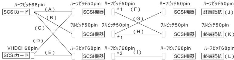
\* 1 : ハーフピッチ50pinもしくはフルピッチ50pinのSCSI機器に、ハーフピッチ68pinのSCSI機器をデイジーチェーン接続することはできません。
