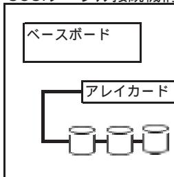
SCSIケーブル接続機構を適用するとSCSIケーブルはSCSIアレイコントローラカードに接続されます。
