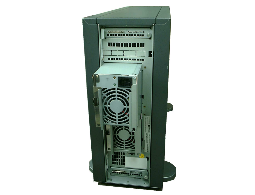
図 10：電源ユニットを取り外した状態
