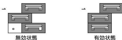
図2-2.SCSI終端抵抗設定スイッチ( CNH 1 )の設定
