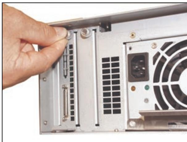
図 17 : SCSI インタフェースモジュールのネジをゆるめる
