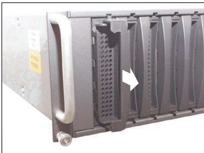
図 13 : ハードディスクユニットの引き出し
