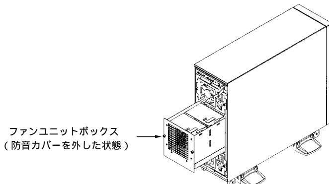
ファンユニットボックスについているネジ2ヵ所をゆるめ、ファンユニットボックスを手前に静かに引き抜きます。
