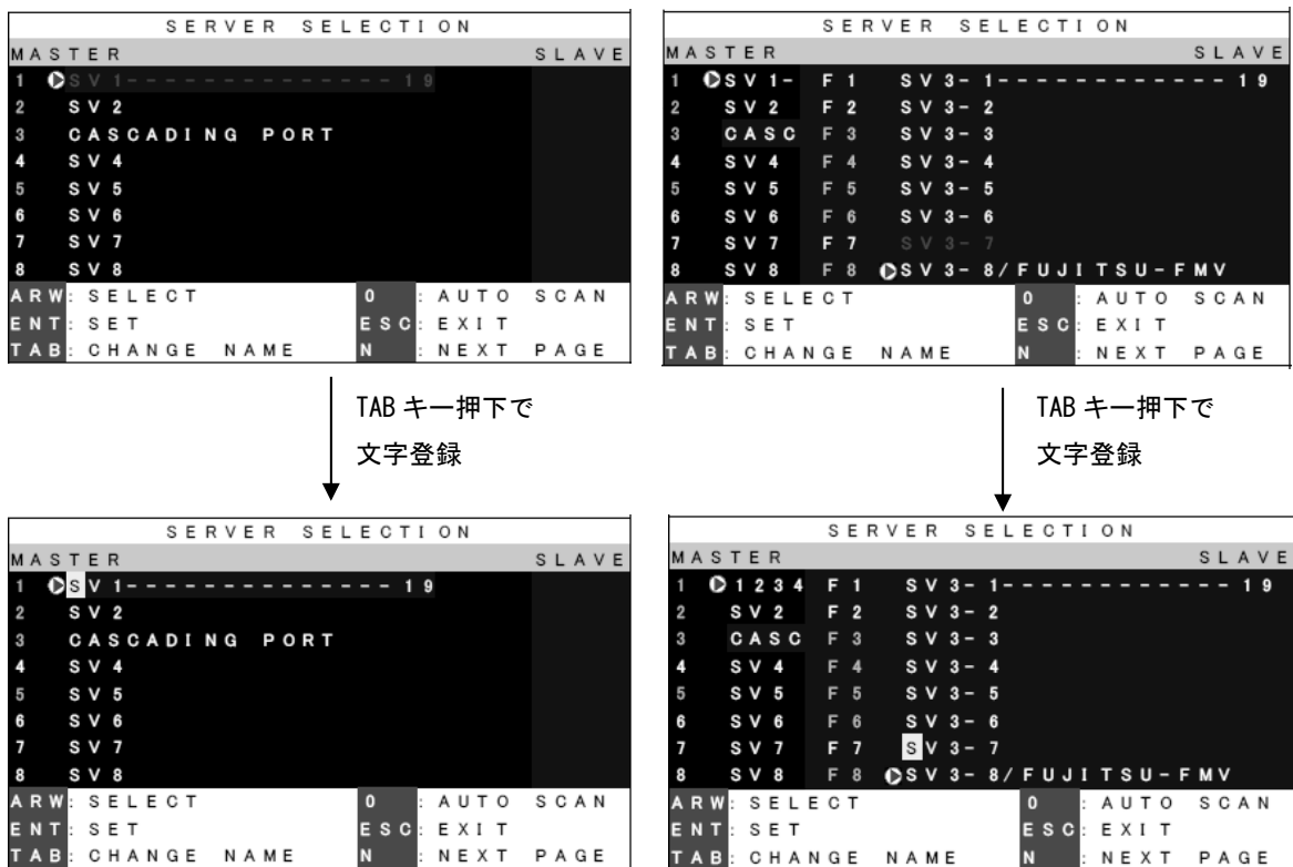
マスター側登録名称変更例 (本装置単体の時も同様、但し青色部分未表示)
