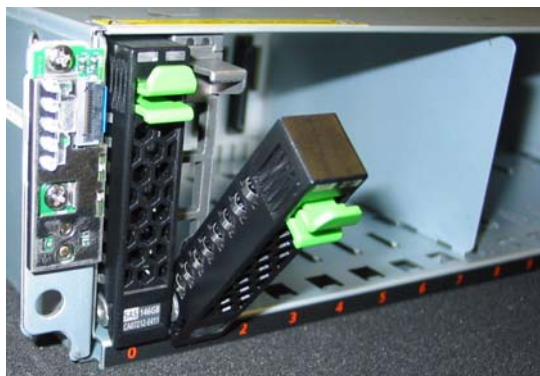
図 15：ハードディスクドライブの取り外し / 取り付け
