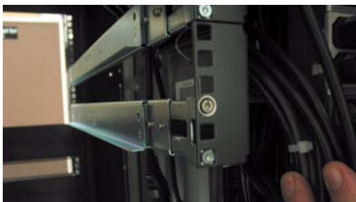
図 25 : 左側のスライドレール (2 個のエンクロージャに 2 個、背面ラック)
