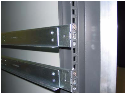
図 24 : 右側のスライドレール (2 個のエンクロージャに 2 個、前面ラック)
