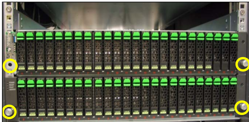
図 27 : サブシステムの固定 (2 U)
