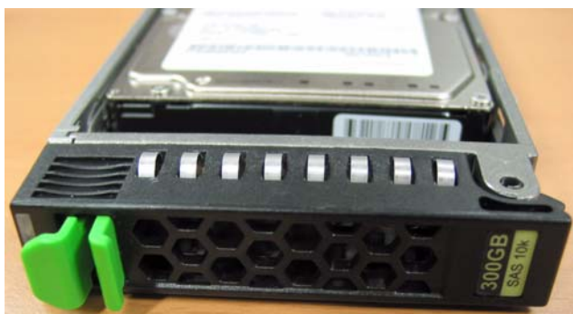
図 12 : フレームに取り付けられたハードディスクドライブ
