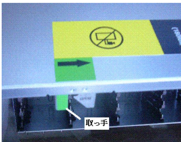
図 5.22 上面カバーの取り外し
