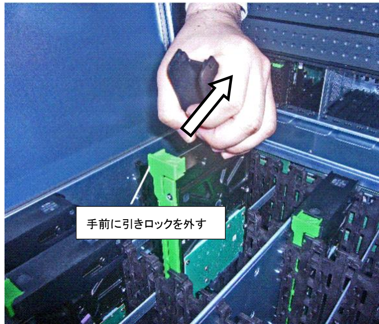
図 5.24 ドライブの取り外し
