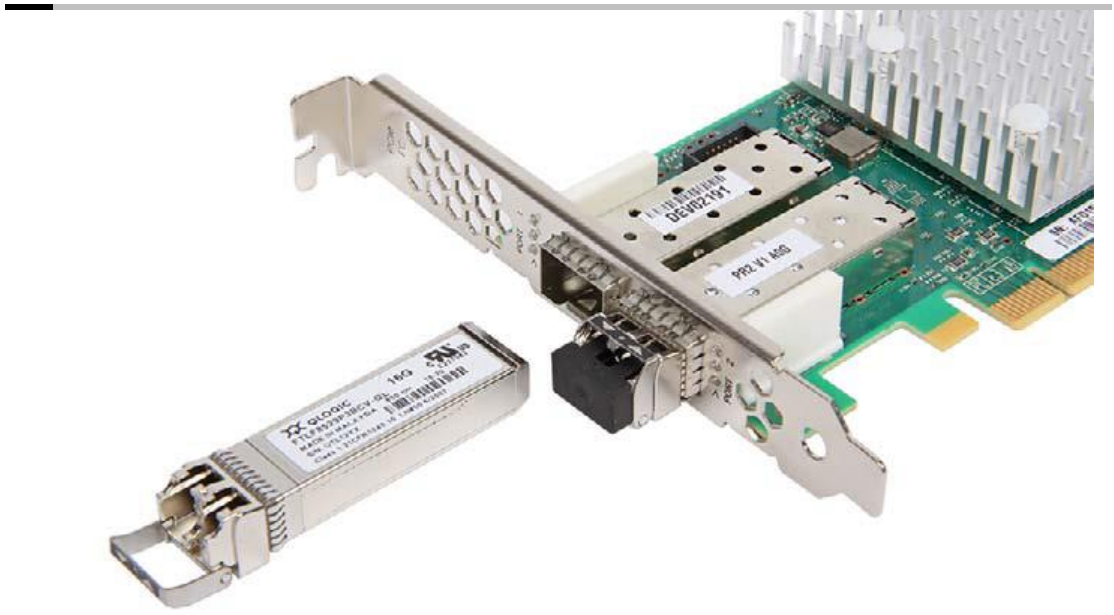
図 4: 光トランシーバモジュールの取り外し
