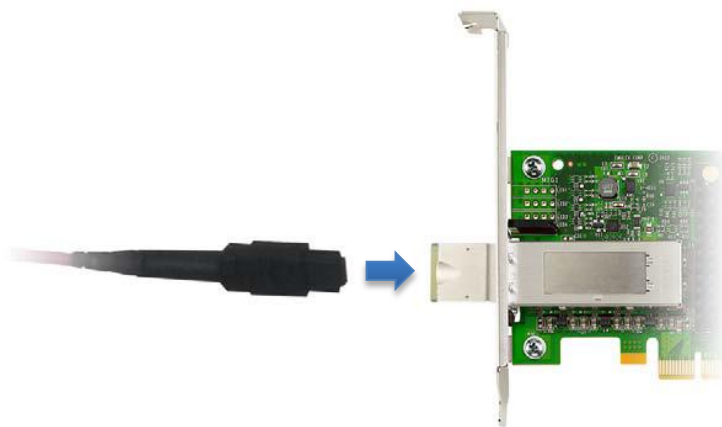
図 2-3 光ケーブルの接続
