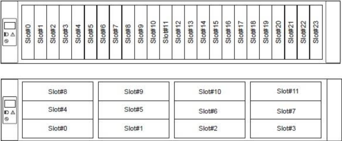
図 4.5 2.5/3.5 インチドライブのスロット番号
