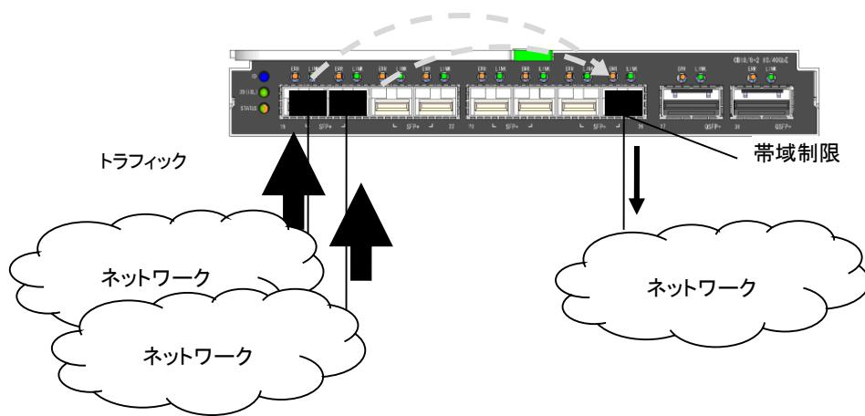
本装置は、出力の制限値を設定し、帯域幅をポート単位で制御します。トラフィックの帯域幅がしきい値を超えた場合は、帯域幅を超えるトラフィックが破棄されます。
