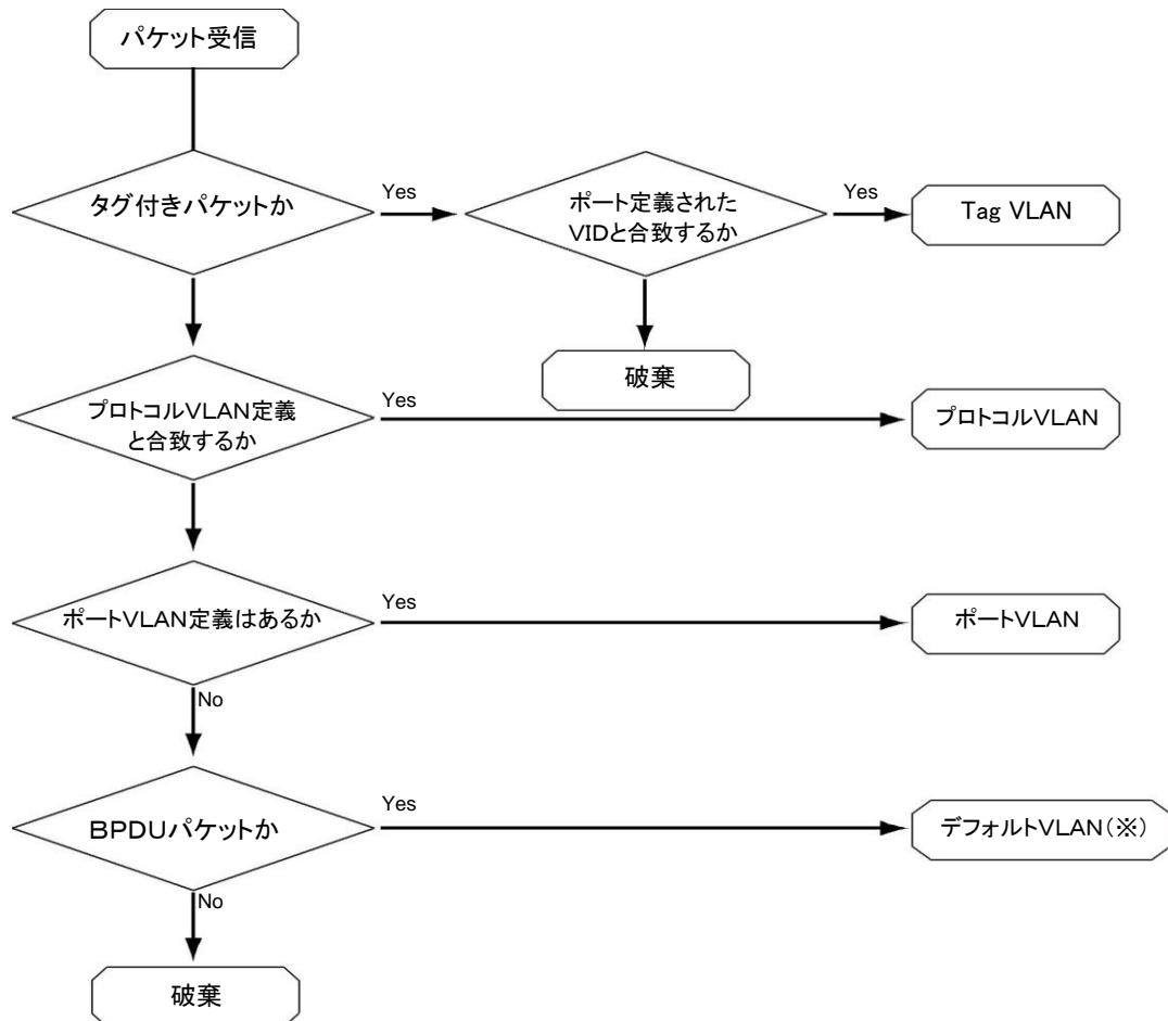
※) 本装置では、構成定義でTag VLAN／プロトコルVLANが定義され、かつ、ポートVLAN (untagged) が未設定のポートに対しては、BPDUパケットを受信するために装置内でデフォルトVLANを作成します。
