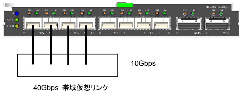
トランク・グループへのトラフィックは、送信パケットのMACアドレスまたは、IPアドレスで判断し、負荷分散します。
