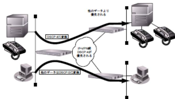
DSCP値書き換え機能は、IPv4 [RFC791] で定義されている IP パケットヘッダにある8 ビットのType Of Service (TOS) フィールドおよびIPv6 パケットヘッダにある8 ビットのTraffic Class フィールドのうち、DSCPフィールドを制御することができます。
