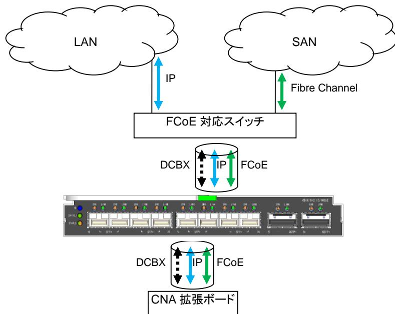
CEE (Converged Enhanced Ethernet) 機能とは、従来の LAN, IPC, SAN など、タイプの異なる通信を一つのネットワークに統合するために必要な拡張を Ethernet に追加したものです。SAN (Storage Area Network) のプロトコルである Fibre Channel を Ethernet で送受信するための FCoE (Fibre Channel over Ethernet) 等で利用されます。本装置では、CEE 機能として以下の要素技術をサポートしています。
