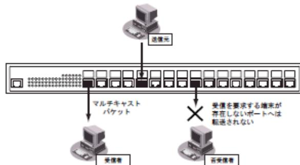
本装置のポートで、マルチキャストルータが接続されたマルチキャストルータポートまたはリスナが存在するポートとして認識される条件を、以下に示します。
