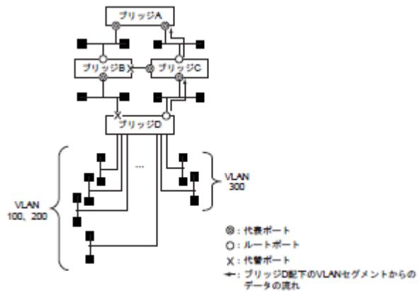
MSTP を使用すると、「インスタンス1 でのスパンニングツリーとVLAN100、200 のデータの流れ」、「インスタンス2 でのスパンニングツリーとVLAN300 のデータの流れ」のようにVLAN単位でのロードバランシングが可能ですが、STP のみの場合は、以下のようにVLANに関係なくスパンニングツリーが作成されるためデータが偏ります。
