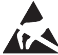
静電気敏感性コンポーネントを含むモジュールの表示
