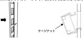
2. 取付け治具先端の引込み用の爪をケージナット取付け穴の手前から挿入し、 ケージナットのもう一方の爪に勘合させます。
