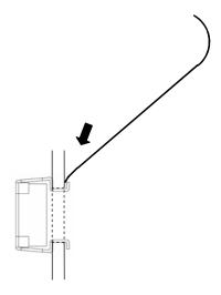
2. 取付け治具をケージナットの方へ押し下げて取外します。
