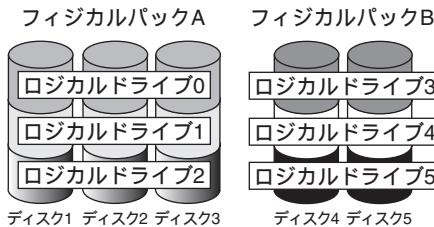
この場合、ディスク 1 ~ 3 (ディスク 4 ~ 5) は同容量同種類のハードディスクを使用してください。また、ロジカルドライブ 0 ~ 2 とロジカルドライブ 3 ~ 5 はそれぞれ同じ RAID レベルに設定してください。
