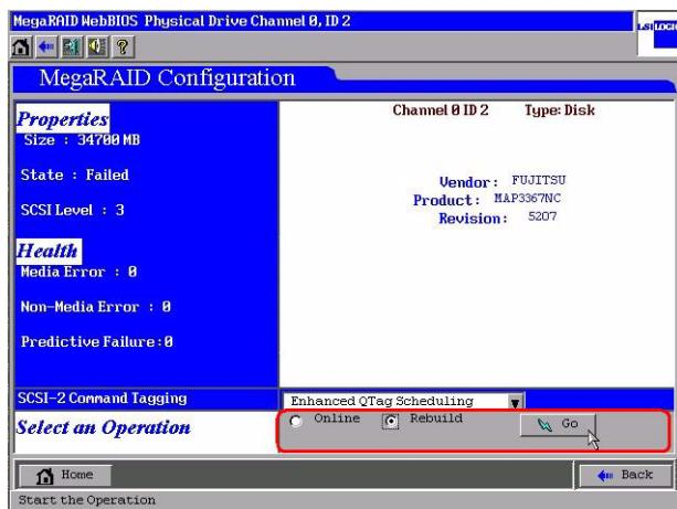
リビルド処理が開始され、「State」が「Rebuild」に変わります。
