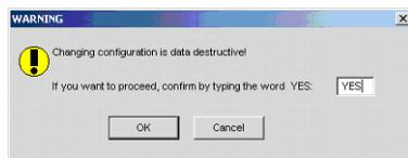
手順6で「Init Drive」にチェックを行った冗長ドライブ（RAID1、RAID5）がある場合、次のような画面が表示されます。
