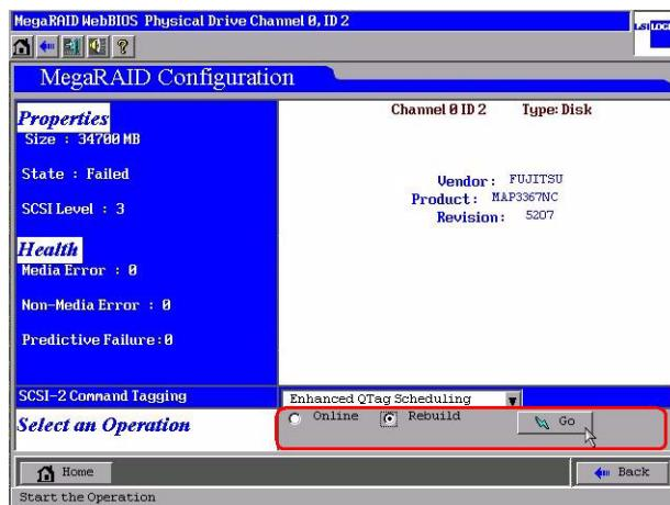
リビルド処理が開始され、「State」が「Rebuild」に変わります。「State」が「Online」の表示にならリビルドは完了です。リビルドが終了したら、[Home] をクリックしてください。
