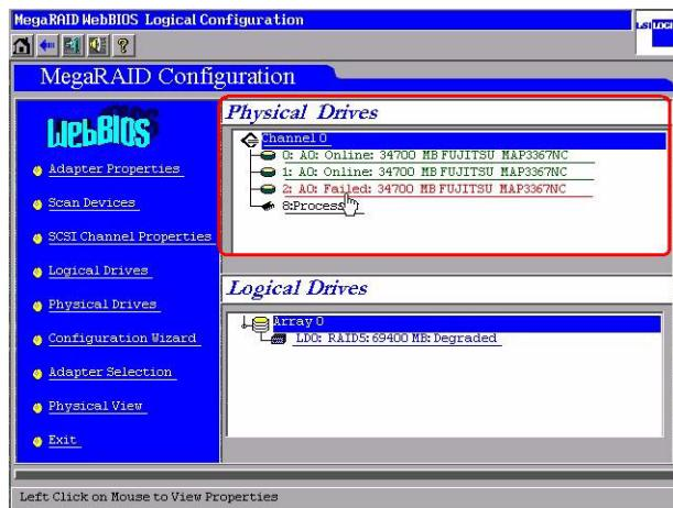
4 次の画面が表示されたら「Rebuild」を選択し、[GO] をクリックします。
