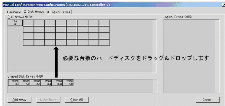
画面左下の「Unused Disk Drives」エリアには、未使用状態のハードディスクの一覧が表示されます。ここから未使用のハードディスクを選択し、「Disk Array A0」のエリアにドラッグ & ドロップします。ドラッグ & ドロップされたハードディスクは、フィジカルパック A0 を構成するハードディスクとなります。1 つのフィジカルパックに対して最大 16 台までハードディスクを追加することができます。
