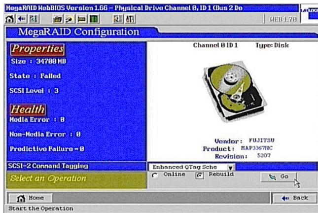
リビルド処理が開始され、「State」が「Rebuild」に変わります。
