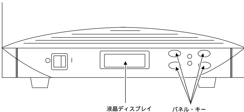
液晶ディスプレイには、メニューおよびエラー情報、カートリッジの状態、フロントドアのロック状態が表示されます。
