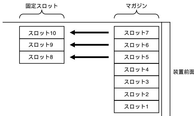
マガジンから本装置内部の固定スロットへカートリッジを移動させる手順は、以下のとおりです。
