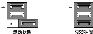
図2-2.SCSI終端抵抗設定スイッチ(CNH1)の設定
