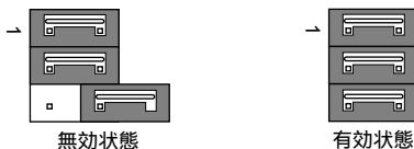
図2-2.SCSI終端抵抗設定スイッチ(CNH1)の設定
