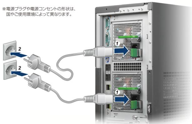
1. 電源ケーブルを、サーバ本体背面の電源コネクタに接続します。
