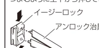
片方の手で支えながら、ロックを解除したスライドレールを背面側に押し込んで取り外します。
