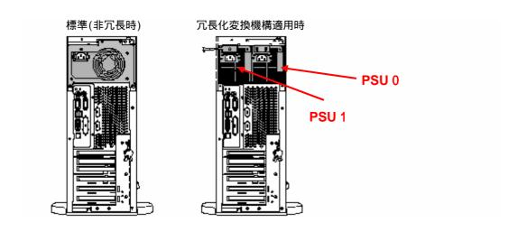
ラックマウント変換機構適用時は、上部が PSU0、下部が PSU1 となります。
