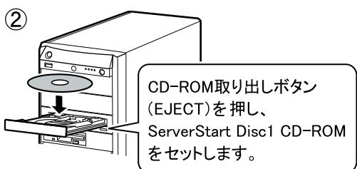
セットせずにいると、ServerStart CD-ROM をセットするようメッセージが表示されます。ServerStart Disc1 CD-ROM をセットして【Ctrl】+【Alt】+【Delete】キーを押してください。
