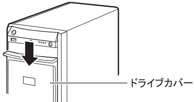
**3** サーバ本体の電源を入れ、すぐに ServerStart Disc1 CD-ROM をセットします。
