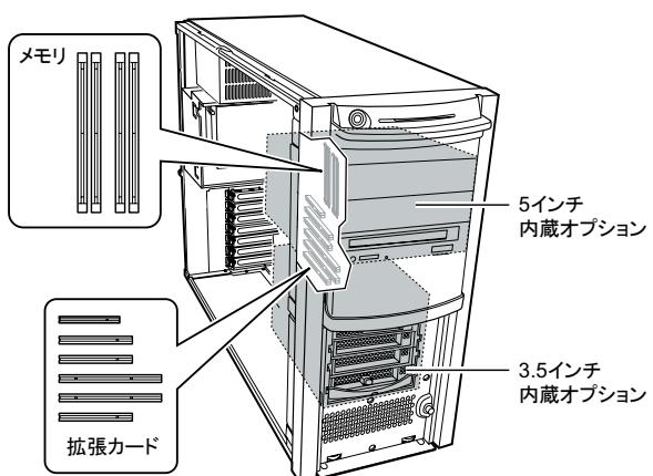
内蔵オプションを搭載後、搭載場所や搭載順序が正しいこと、ケーブルが確実に接続されていることを確認してください。
