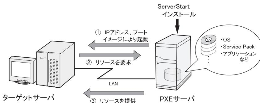
PXEサーバを使ったリモートインストールでは、PXEサーバのほかに、リモートリソースを格納する「リモートリソースサーバ」とDHCPサービスを行う「DHCPサーバ」が必要です。サーバが1台しかない場合は、PXEサーバにリモートリソースを格納してDHCPサービスをインストールしてください。複数台のサーバがあるときは、DHCPサービスを行うサーバ、リモートリソースを格納するサーバをそれぞれ決定してください。
