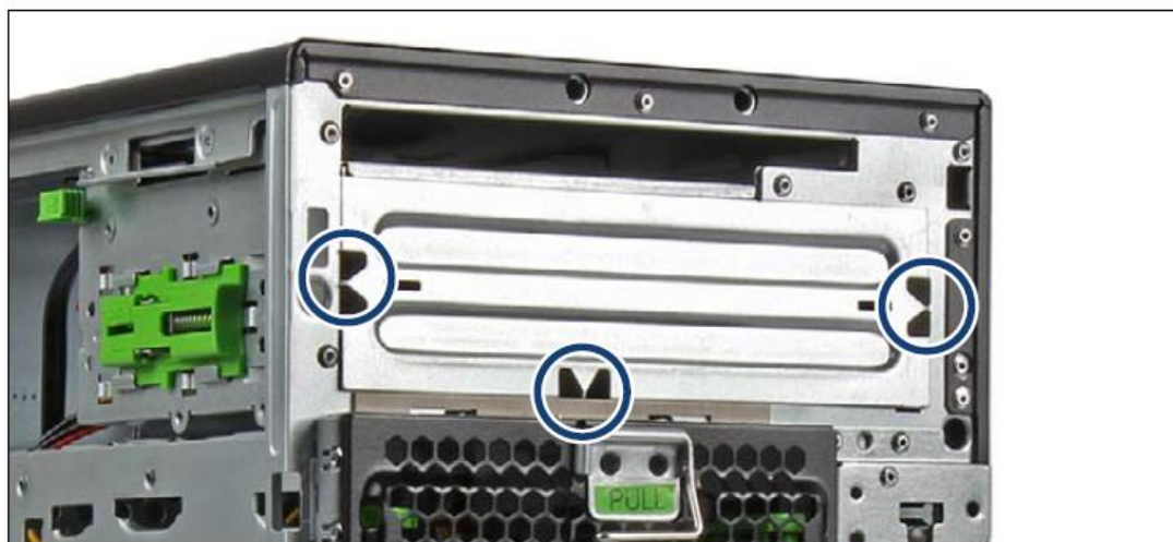
図 97: ベイ 2 のメタルベイカバーのポイントの固定
