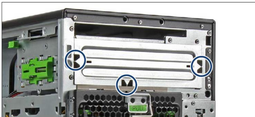
図 97: ベイ 2 のメタルベイカバーのポイントの固定
