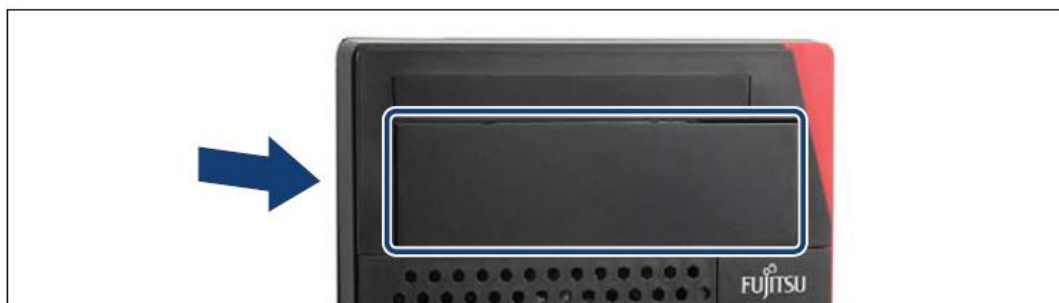
図 96: ダミーカバーベイ 2 の取り外し
