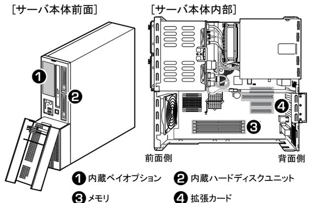
内蔵オプションを搭載後、搭載場所や搭載順序が正しいこと、ケーブルが確実に接続されていることを確認してください。
