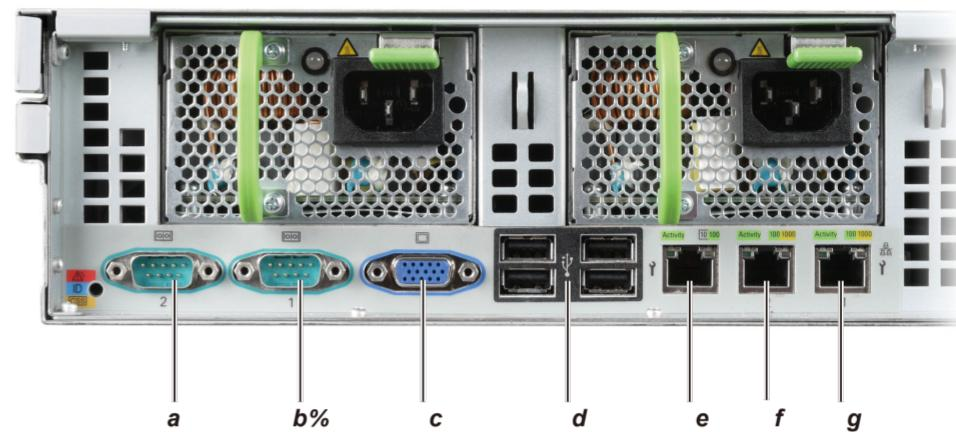
**a** シリアルコネクタ(COM2) **b** シリアルコネクタ(COM1) **c** ビデオコネクタ **d** USBコネクタ(x4) **e** サービスLANコネクタ **f** システムLANコネクタ(LAN2) **g** 共有LANコネクタ(LAN1)
