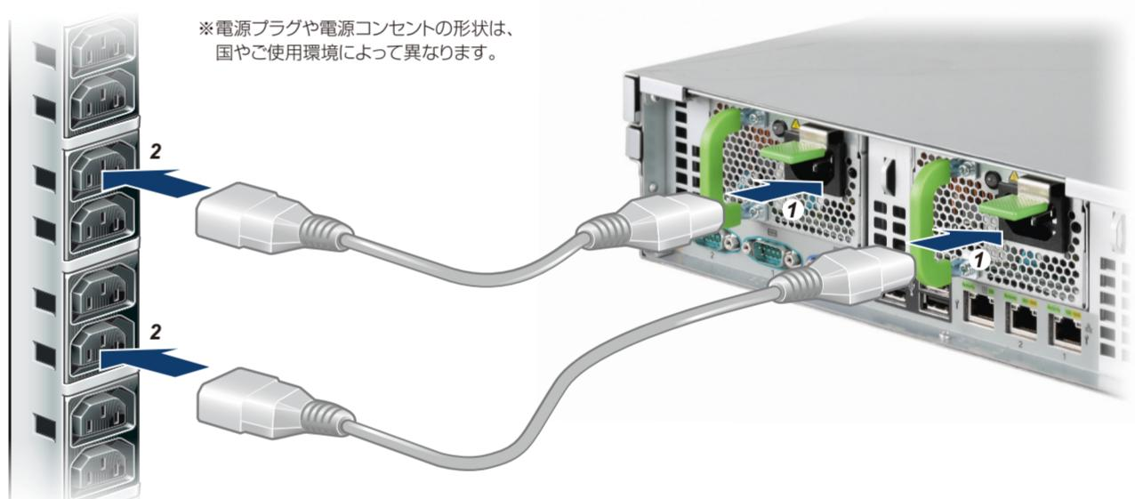
1. 電源ケーブルを、サーバ本体背面の電源コネクタに接続します。
