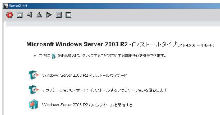
**8** [(OS) インストールウィザード] をクリックし、ウィザードに従って OS インストールタイプの開封情報を入力します。
