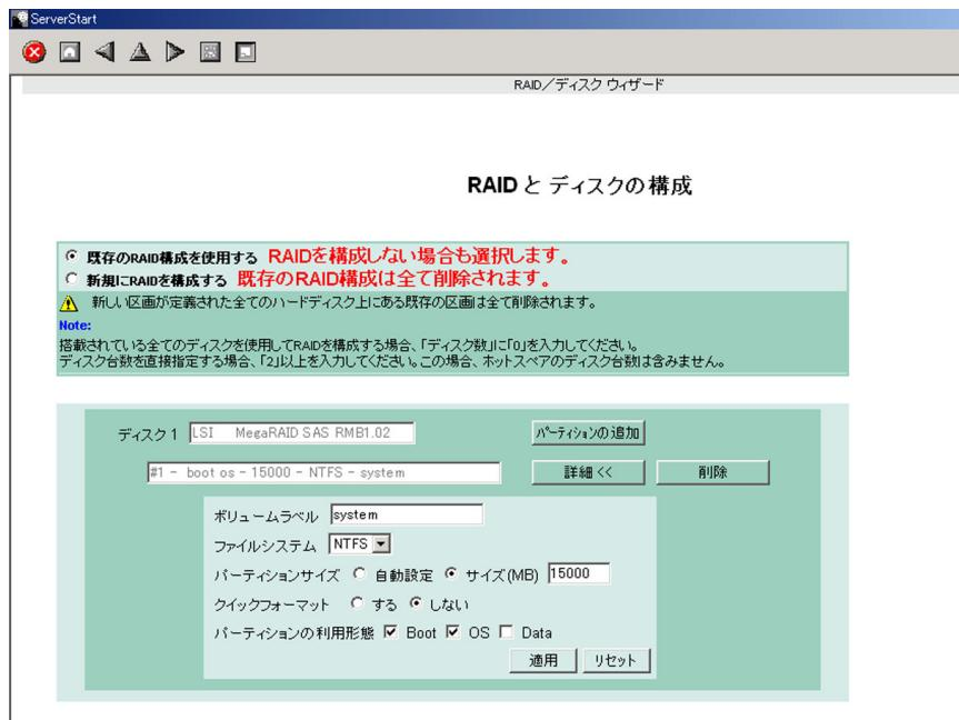
パーティションの構成が表示されます。デフォルト値が設定されていますので、内容を確認し、必要に応じて設定を変更します。
