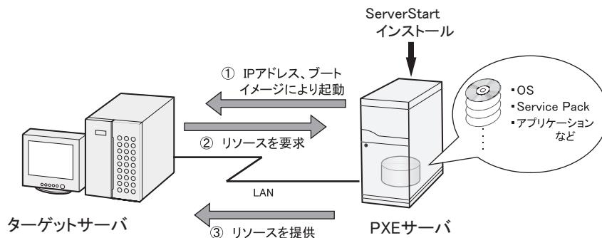
PXEサーバを使ったリモートインストールでは、PXEサーバのほかに、リモートリソースを格納する「リモートリソースサーバ」とDHCPサービスを行う「DHCPサーバ」が必要です。サーバが1台しかない場合は、PXEサーバにリモートリソースを格納してDHCPサービスをインストールしてください。複数台のサーバがあるときは、DHCPサービスを行うサーバ、リモートリソースを格納するサーバをそれぞれ決定してください。
