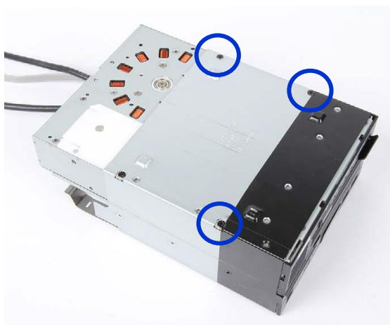
図 313 a: LTO ドライブの取り外し - ネジ 3 本固定タイプの場合
