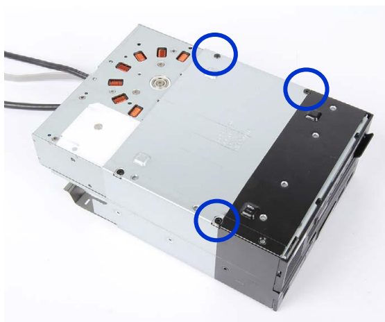
図 304 a: LTO ドライブの取り付け(B) - ネジ 3 本固定タイプの場合
