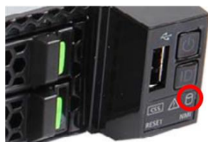
フロントパネルの HDD アクセス表示ランプ
