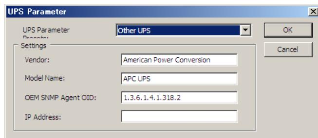
**5 「UPS Parameter Presets」を選択し、「IP Address」を入力します。**
