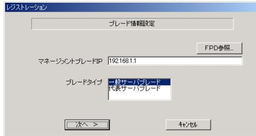
1. マネジメントブレードの IP アドレスは装置に設定されている値が表示されます。値が正しいかどうか、確認してください。
