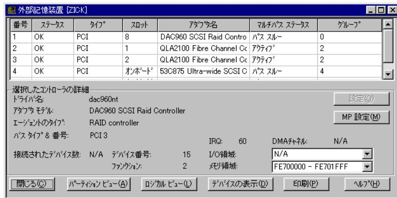
MultiPath を使用すると、複数の HBA (ホストバスアダプタまたはファイバチャネルホストバスアダプタ) を、冗長パスを経由して同一の記憶装置に接続できます。MultiPath により、接続や HBA の障害が発生してもデバイスに対する高可用性が得られます。障害が発生した場合、入力や出力は別の I/O パスを経由してデバイスに転送されます。さらに、負荷をより均等に分散するためにロードバランシング機能も提供されます。
