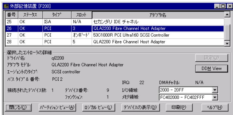
DuplexWrite は、ディスクストレージサブシステムの能力を向上させるソフトウェアです。ファイバチャネル接続技術を共に使用することにより、災害許容設定をセットアップできます。DuplexWrite により、異なるディスクストレージサブシステムの 2 つのディスクに同一の情報が含まれるよう、書き込み操作が複製されます。これは、ファイルシステムデータなどの論理データ構造に依存しないので、「物理ミラーリング」と呼ばれます。いずれかのドライブが失敗すると、まだ動作しているディスクにアクセスして割り込みを行わなくとも、DuplexWrite によりデータの処理を継続できることが確認されます。問題のあるドライブが修復されると、通常の運用中にデータのリカバリを実行できます。再起動は必要ありません。これは、複雑な RAID ボリュームだけでなく物理ディスクにも適用されます。
