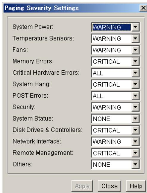
「Temperature Sensors」、「System Hang」項目が、「ALL」、「CRITICAL」、「WARNING」のいずれかに設定されていることを確認します。設定されていない場合は、「CRITICAL」に設定してください。
