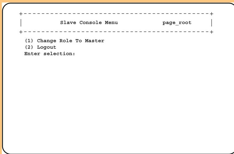
ここで「1. Change Role To Master」を選択して、接続しているマネジメントブレードの動作モードをスレーブモードからマスタモードに変更します。
