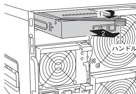
**3** ネットワークブレードまたはダミースイッチブレードを取り付けます。
