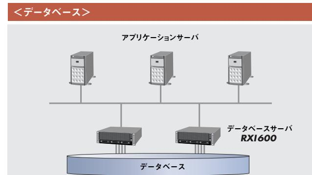
データベースサーバには、日々蓄積する膨大なデータの大量かつ高速な処理が必要とされます。RXI600では、メモリ容量が拡大したOS上で稼働するOracle、SQL Serverにより、データアクセスのスピードを高め、飛躍的なパフォーマンスの向上を実現します。これにより、複数の32bitサーバを統合することができます。
