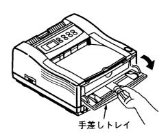
給紙トレイを取り付ける 給紙トレイの金属のフック(2ヶ所)をプリンタの穴 に差し込み、下に下げます。
