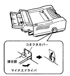
プリンタと給紙トレイに接続コードを取り付ける 給紙トレイ付属の接続コードのコア側をプリンタに 差し込みます。次に接続コードのもう一方を給紙ト レイに差し込みます。
