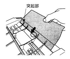
フィルムガイドを貼り付ける 粘着面が下にあることを確認して、そのまま下 におろして給紙トレイに貼り付けてください。
