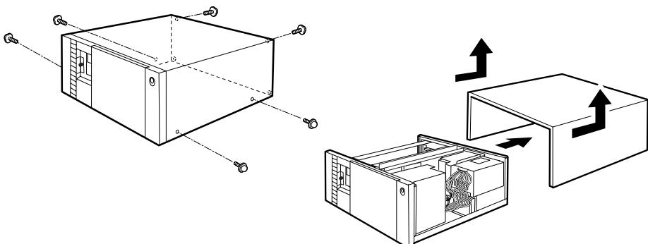
4. ネジ ( 4 か所 ) を外し、取り付け金具を取り外します。
