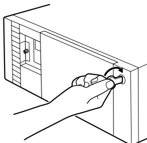
3. アッパーカバーと補強金具を取り外します。
