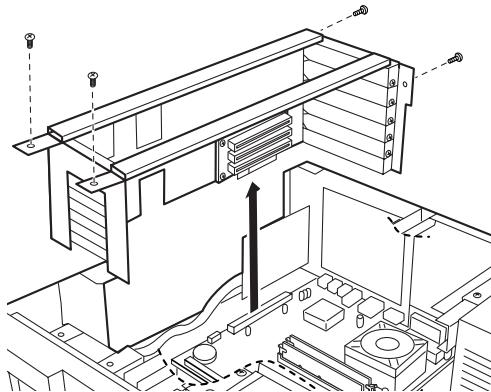
5. ネジを外し、スロットカバーを取り外します。
