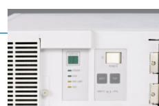
標準装備の基本RAS機能によるアラーム検出(温度、ファンなど)に加え、RASカードとの組み合わせにより、異常時の外部通知や稼働履歴保存など、高いレベルでの信頼性を実現します。
