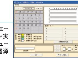
最大12ヶ月のカレンダースケジュールにより、エージェントのスケジュール運転(シャットダウン実行後に電源切断)が可能です。週間スケジュールのほか、祝日や長期休暇など特定日の電源スケジュールをサポートします。また、コンソール側のソフトウェアから、ネットワーク経由でのリモート操作も可能です。
