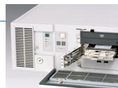
データの保護やシステムの安定稼働を実現するミラーディスクモデルを用意。OSに依存せずに動作するハードウェアRAID機能(RAID-1、ホットスワップ対応)により、不安定要素となる特別なデバイスドライバを使用しない高信頼なRAIDシステムが構築可能。装置添付の「ミラーディスク監視モニタ」と合わせて、迅速なトラブル対応も可能。活性保守に対応し、メンテナンス時にも安心です。
