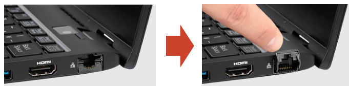
片手で簡単に開閉できるフラップ式有線LANポート
