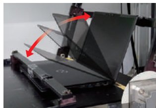
液晶ディスプレイの開閉動作を繰り返し、破損などがなく、耐久性のチェックを行います。
